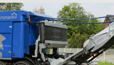
Electroimán de neodimio ajustable hidráulicamente
