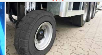
Accionamiento - permite que la máquina avance de forma autónoma vía radio (sólo semiremolque)
