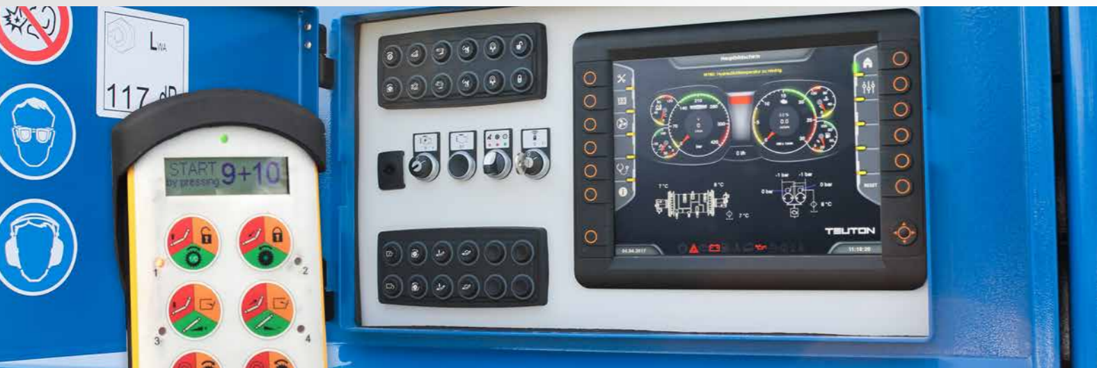
Control via IFM con pantalla táctil 12,1" + control vía radio con display
