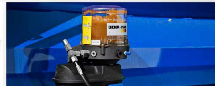
Sistema centralizado de lubricado
