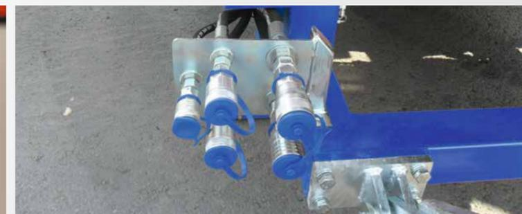
Conexión hidráulica adicional
