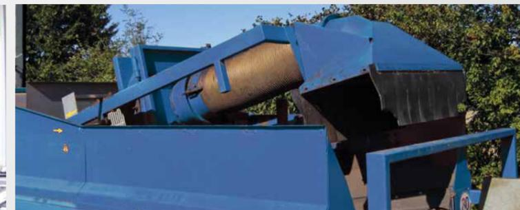
Separador de aire en la cubierta de tamiz grueso
