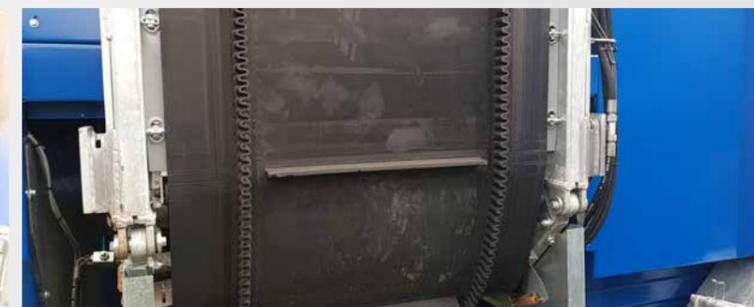
Cinta transportadora con paredes laterales onduladas
