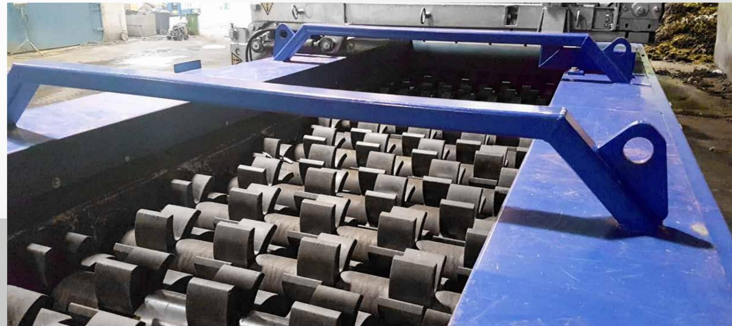
Construcción en forma de cassettes de la cubierta de la criba
