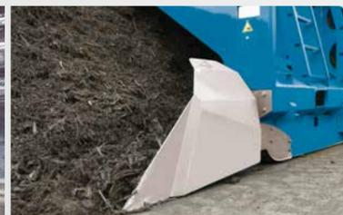
Barredores de paso hidráulicos que se adaptan al contorno del suelo de forma automática
