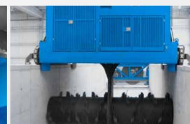
Proceso medio o 100 % automatizado de volteo y del flujo de material
