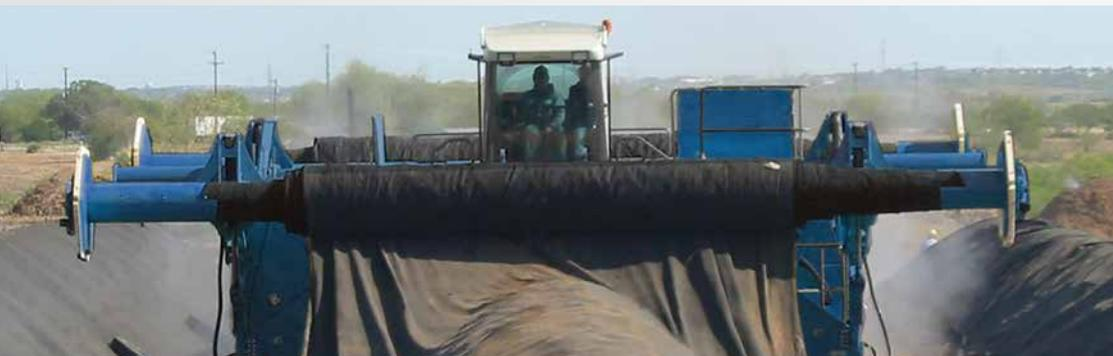
La mejor sinergia: una combinación de volteadora con un enrollador de membranas integrado y el sistema de cobertura por membranas.
