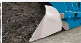
Barredores de paso hidráulicas que se adaptan al contorno del suelo de forma automática
